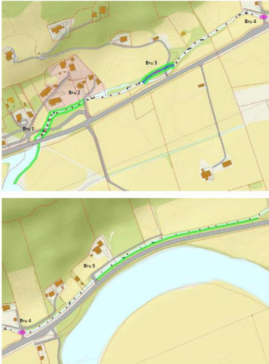
Figur 31. Ytreidselva med tilrådde tiltak. Bunar markert med svarte felt i elva, steingrupper som brune felt i elva, omlegging av elva ved bru 3 markert med blått, utlegging av gyttegrus ved bru 3 og 4 markert med lilla og revegetering av kantvegetasjon markert med blått.
