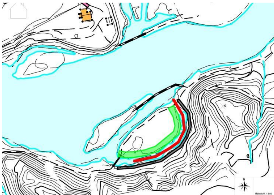
Figur 13. Kroksjøen som kan opnast (raudt), tilrådd etablering av vegetasjonssone på innsida (grønt) og tilrådd plastring med stein på utsida (svart).
