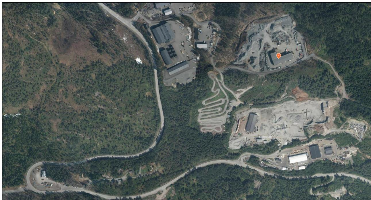
Figur 10 Flyfoto over Stryn miljø og næringspark. Det viser pukkverk i nærleiken av planområde. Pukkverket har også mobilt utstyr. Her vert det teke ut om lag 65.000 m<sup>3</sup> i året. Ressursen er avgrensa og nytt tomtareal kan utløysa tilgjenge til nye ressursar for produksjonen.
