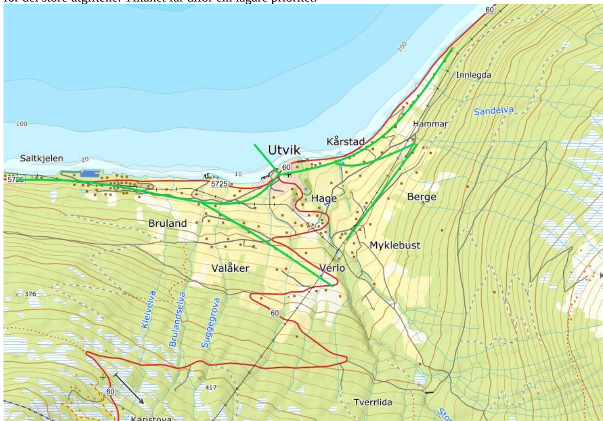
Figur 14: Prinsippskisse av avskjerande leidningar med fellesanlegg med utslepp til fjord.
